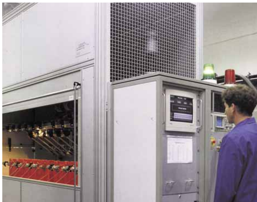
Автоматическая установка для проведения типовых испытаний ОПН в производственном цехе
